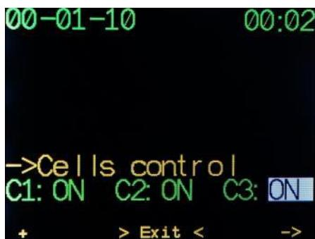
AV1 в режиме ССРможет контролировать РО2 в контуре ребризера с помощью одного, двух или трех кислородных датчиков типа R22, R17 или аналогов. Количество и номер контролирующих датчиков устанавливается в этом пункте меню. Подробнее см. Контроль датчиков РО2
