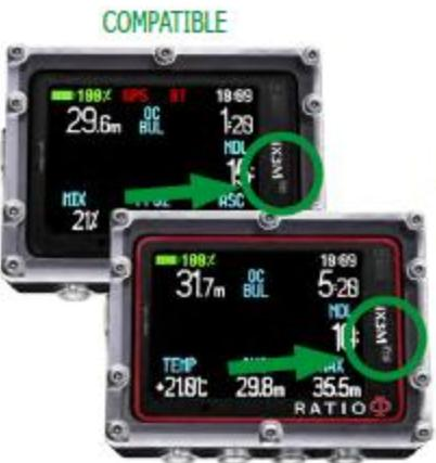
Модель iX3M, имеющая на поверхности экрана надпись «iX3M GPS» или «iX3M PRO» совместима с данным трансмиттером.
