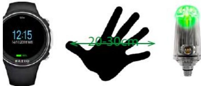
TX ID: (0-1 для легких погружений, 0-2 для глубоких, 0-9 for Tech+): Пользуйтесь кнопками B and D для выбора баллона, к которому подсоединен трансмиттер (проверьте значение MIX при определении баллона).
