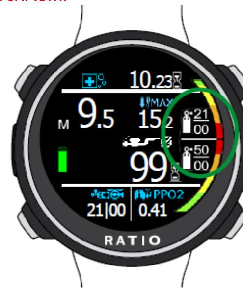
Цветной дисплей iDive отражает давление в баллоне цветовой индикацией, в правой части экрана. Нажмите D для просмотра давления в нижней части дисплея.
